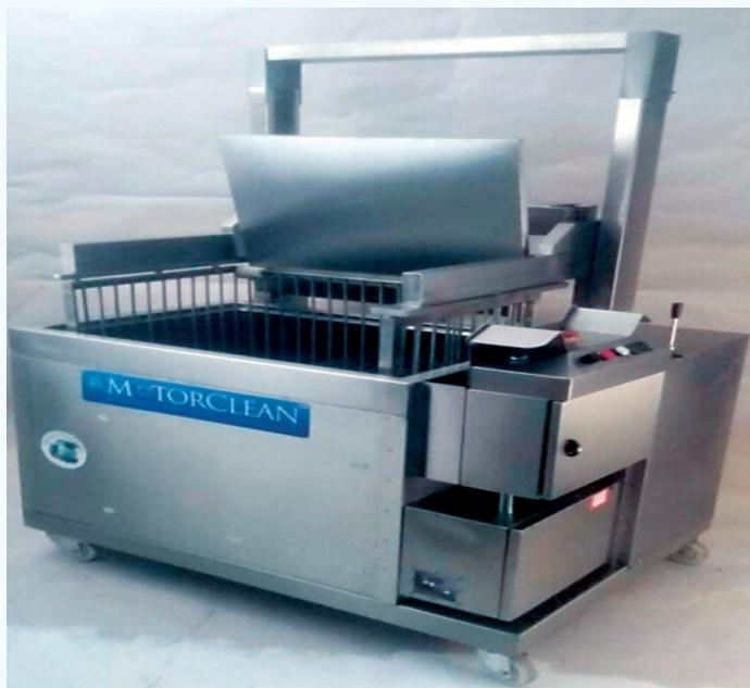
Nosso sistema é composto por um equipamento com borbulhador (ar comprimido), resistência de 2 a 4 kw, com uma solução aquecida a 80°C, que dura até 30 dias, não tóxica, não corrosiva (pH 10,4) e biodegradável, onde os motores e peças são imersos por certo período de tempo, após a imersão enxague apenas com água fria, e com extrema facilidade e eficiência, graxas, óleo e sólidos carbonizados ainda restantes dentro de dutos e galerias serão removidos.
