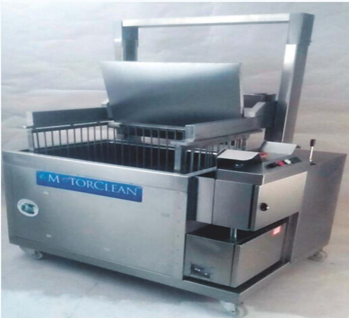
Nosso sistema é composto por um equipamento ultrassônico, resistência de 2 a 4 kw, com uma solução aquecida a 80°C, que dura ate 30 dias, não tóxica, não corrosiva (PH 10,4) e biodegradável, onde os motores e peças são imersos por certo período de tempo, após a imersão enxague apenas com água fria, e com extrema facilidade e eficiência, graxas, óleos e sólidos carbonizados ainda restantes dentro de dutos e galerias serão removidos.
